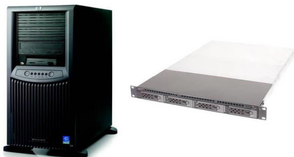
Слика 1. Серверска платформа у варијанти вертикалног и "RACK" кућишта
